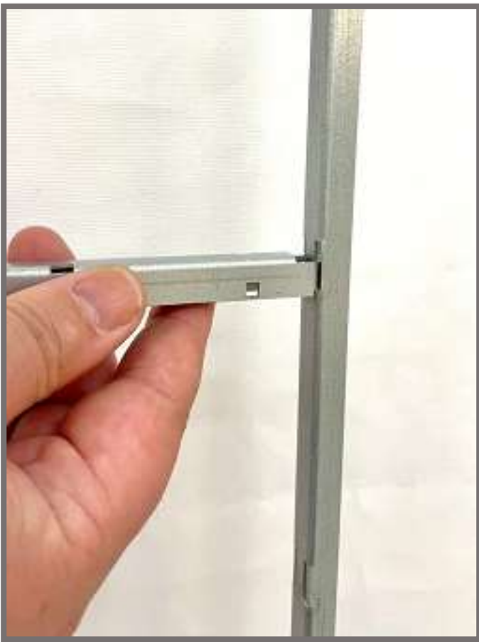
Kuva 9. Laita haluttu orsi varren sivureiän lävitse haluamastasi ripustuskorkeudesta ja toista sama toisella päädyllä. Orsi tulee asettua hahloistaan varteen. Näin varmistetaan hyvä maadoitus myös seuraavilla käyttökerroilla.
